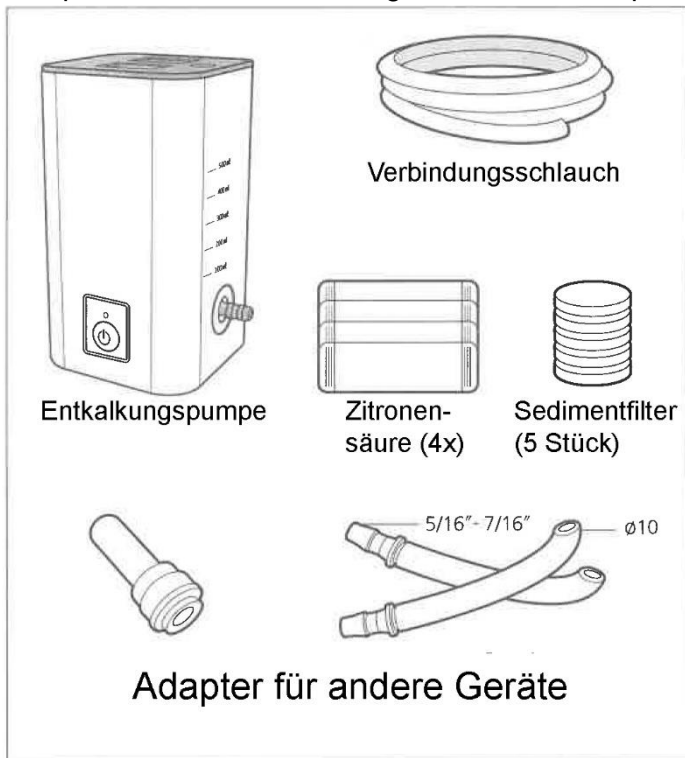
Abb. 1: Details der Entkalkungspumpe
