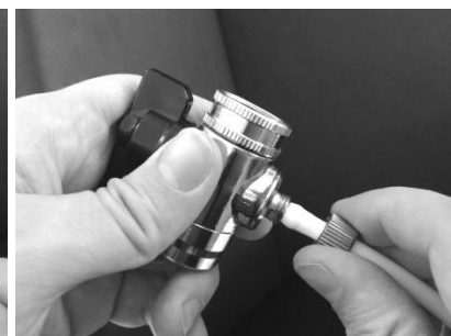
Schlauch über Nippel schieben ( Tip : Schlauchende in heißes Wasser halten, dann wird der Schlauch weicher und lässt sich einfacher montieren)
