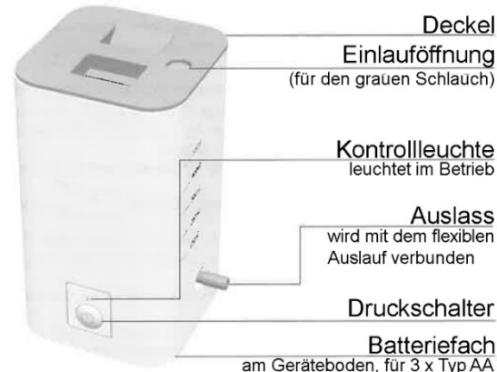
Abb. 1: Details der Entkalkungspumpe
